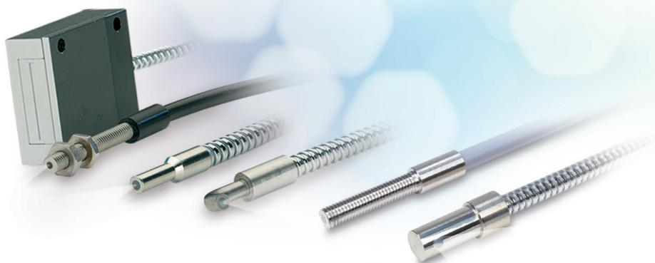
Beim Reflexsensor wird das vom Controller ausgesendete infrarote Licht über die Glasfaser-Lichtwellenleiter des Sensors zum detektierenden Objekt geleitet und dort reflektiert. Im zurück reflektierten infraroten Licht sind sowohl diffuse als auch direkt reflektierte Anteile vorhanden. Die reflektierten Lichtanteile des zu detektierenden Objektes werden vom selben Sensor aufgenommen und über den Lichtwellenleiter zurück zum Controller übertragen und dort ausgewertet.
