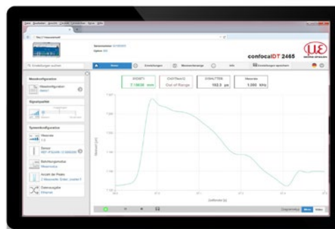
L'interface web permet de procéder à tous les paramétrages. Une base de données de matériaux extensible à volonté existe pour la mesure d'épaisseur.
