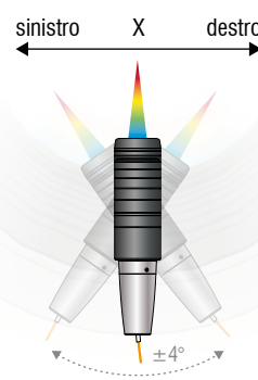
❸ Max. ribaltamento in X \pm 4^\circ
