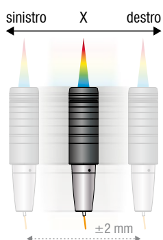
❶ Max. spostamento in X \pm 2 mm
