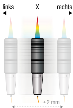
❶ Max. Verschiebung in X \pm 2 mm
