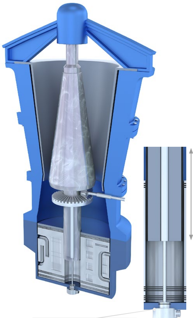
EDS-F: Messung des Mahlspalts in Gesteinsbrechern
