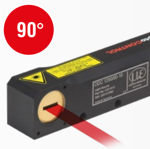
optoCONTROL 1200/90: Ausführung mit 90° Strahlengang für die Montage in engen Bauräumen. Befestigung optional mit Montageschiene ODC1202-L als C-Rahmen.
