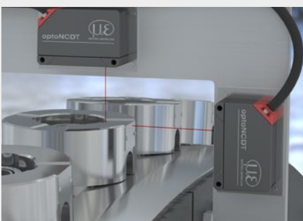
Dimensionsprüfung von Drehteilen
