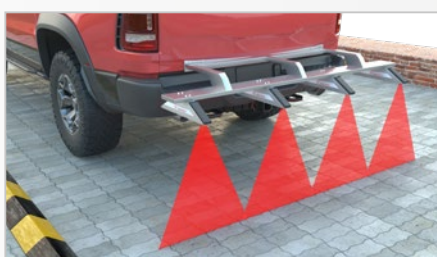
Rilevamento di profili di carreggiata
