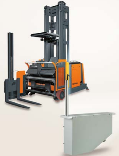
拉绳传感器用于测量叉车的 举升高度
