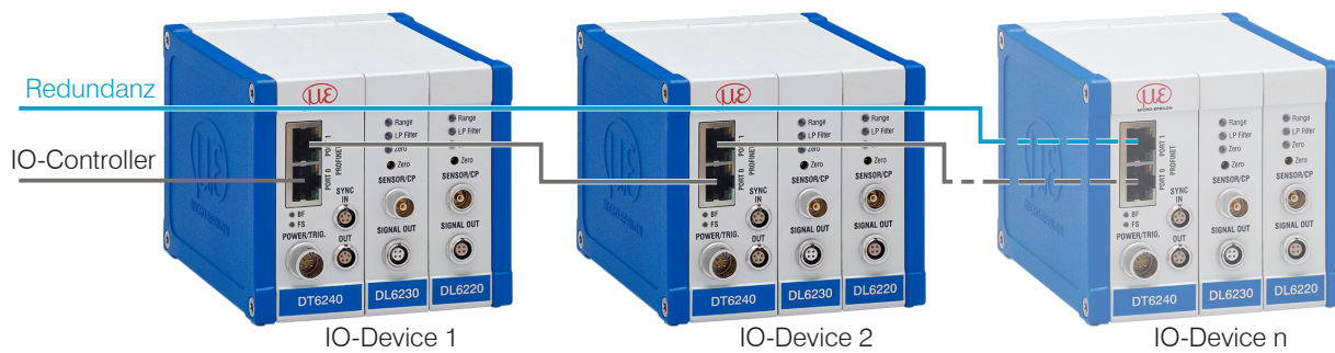
Abb. 4.15: Verkabelung im PROFINET IO-Netzwerk
