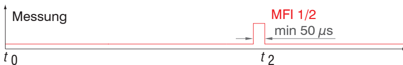
Abb. 6.23: Ablaufdiagramm für die Rücknahme Nullsetzen, Mastern
