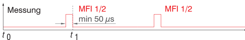
Abb. 6.22: Ablaufdiagramm für Nullsetzen, Mastern (Taste Multifunction)
