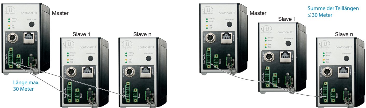
Abb. 18 Synchronisierung mehrerer Controller, links sternförmig, rechts verkettet
