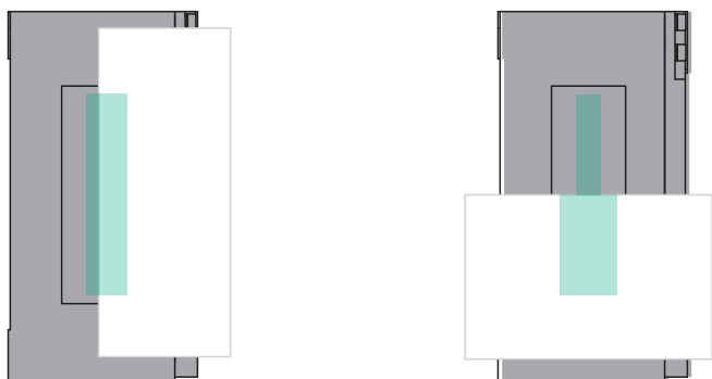
Abb. 4.12: Justagekontrolle mit Projektionsschirm (Papier) vor dem Empfänger, links vertikale und rechts horizontale Orientierung
