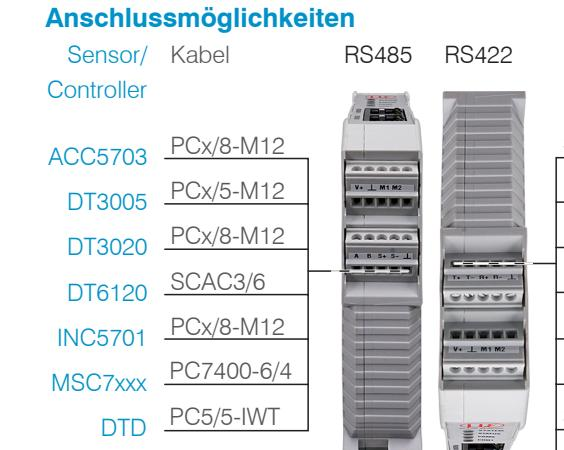
Die Kabellänge zwischen IF2035-PROFINET und Sensor/Controller beträgt maximal 10 m. Für den Sensor INC5701 ist wegen des Kabels PCx/8-M12 eine Sensorversorgung ausschließlich über das IF2035-PROFINET möglich.
