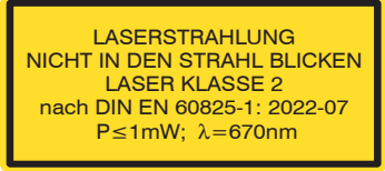
Laserhinweisschild am Sensorkabel
