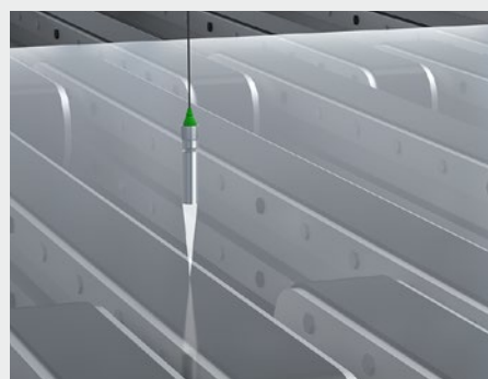
Misurazione dello spessore del vetro piano
