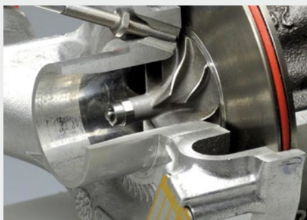
Misurazione della velocità di rotazione dei turbocompressori
