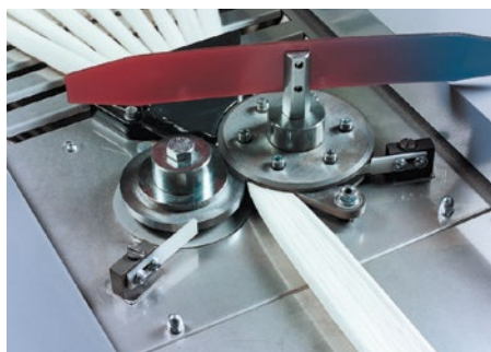
Misurazione dello spessore del filato in linea
