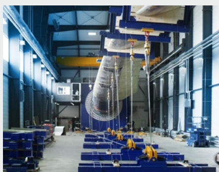
Misurazione della deformazione di pale di rotore per centrali eoliche
