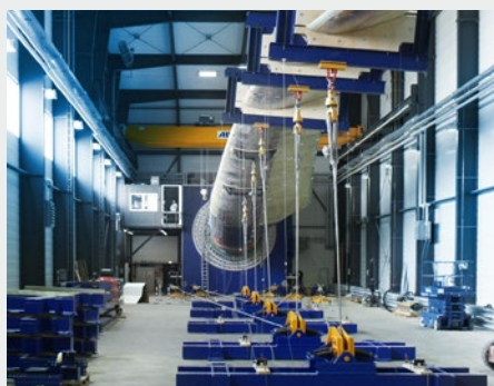
風力発電機の回転翼の変形測定
