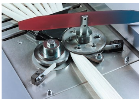
インラインでの糸の太さ測定
