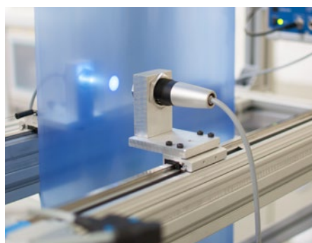
透明箔やアクリルガラスの色階調をインラインで計測
