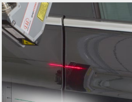
車体部品のギャップ/面一性測定
