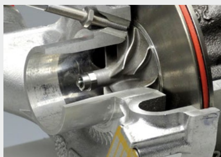
Mesure de vitesse de rotation des turbocompresseurs
