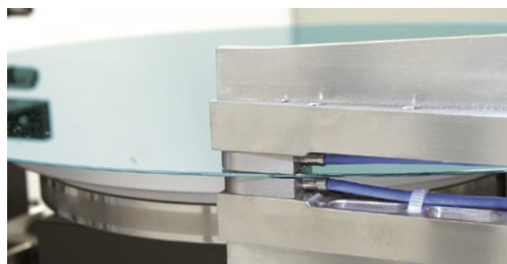
双电容传感器测量晶圆厚度
