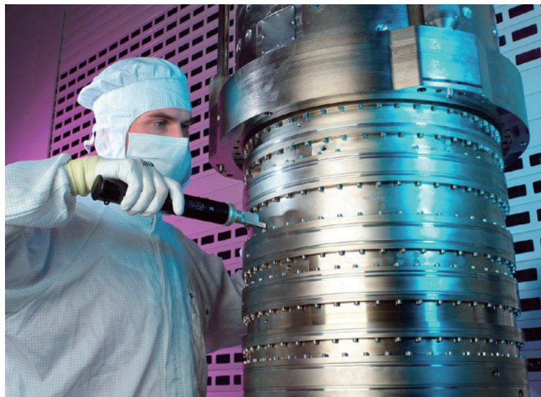
电容位移传感器用于晶片曝光光学系统中透镜的纳米级精度调整。
