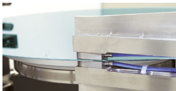
2台の静電容量式センサによるウェハー厚さ測定
