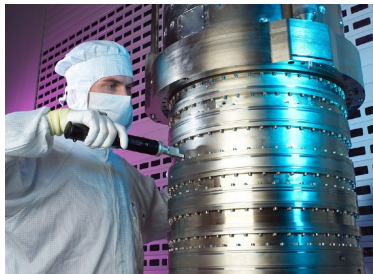
静電容量式変位計センサは、ウェハー露光用の対物レンズのレンズをナノメートルレベルで調節するために採用されています。
