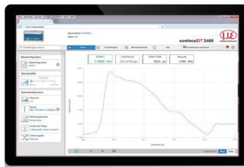
所有设置均在网页界面中执行。对于厚度测量，材料折射率存储在可扩展的材料数据库中。
