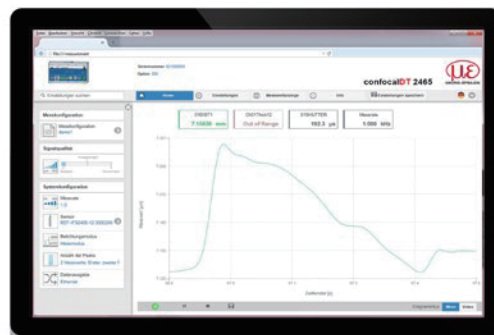
通过网页界面进行设置。对于厚度测量，材料折射率在可扩展的材料数据库中。
