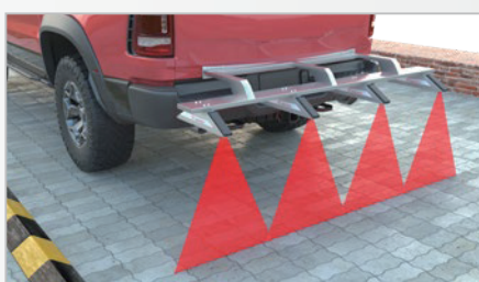
路面轮廓检测
