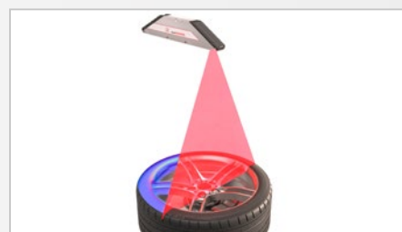
Contrôle 3D en ligne de la géométrie des pneus
