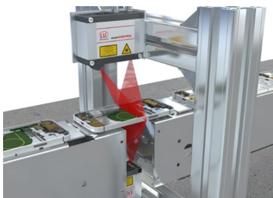
L'épaisseur des plaques supports de smartphones
