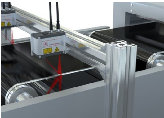
Ampiezza, spessore e Heavy Edge su pellicole delle batterie
