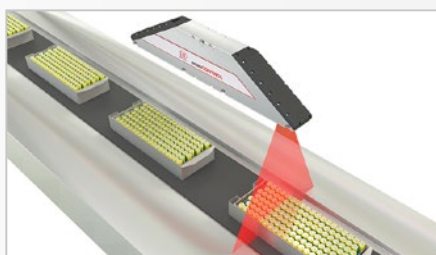
배터리 팩 조립 공정 모니터링
