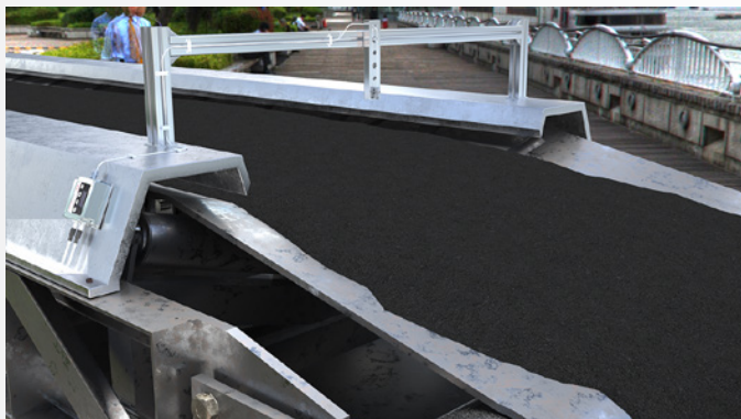
Verifica della temperatura di lavorazione durante il caricamento del catrame con thermoMETER UC
