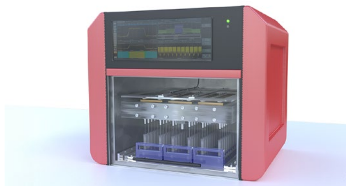
thermoMETER FIによるDNA分析装置内の試料の温度測定
