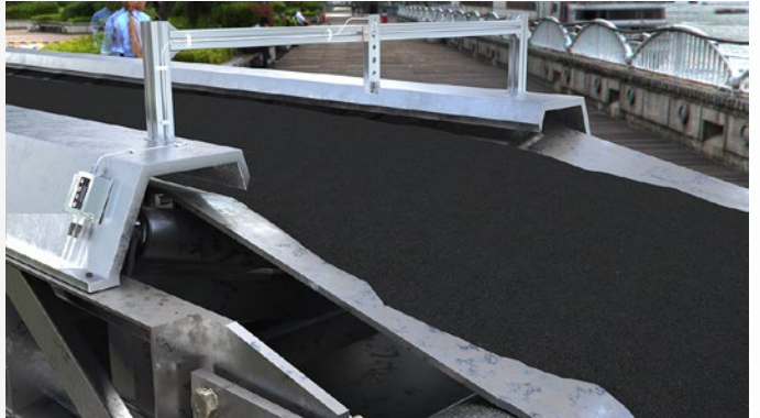
아스팔트 적재 시 thermoMETER UC를 이용한 공정 온도 측정
