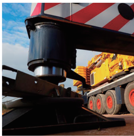
移动式起重机可变支撑装置
