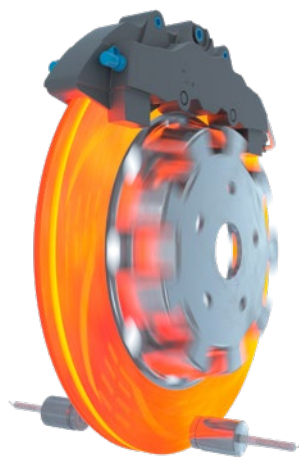
Mesure d'épaisseur des disques de frein
